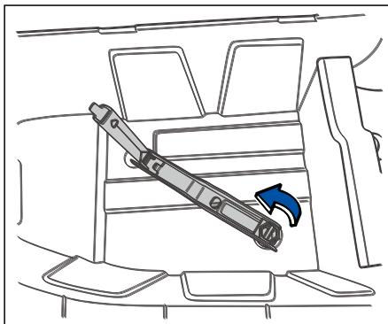
3. Используйте гаечный ключ для колесных гаек, чтобы повернуть стопорный болт запасного колеса против часовой стрелки, чтобы опустить запасное колесо. После того, как запасное колесо коснется земли, продолжайте поворачивать гаечный ключ против часовой стрелки и выньте запасное колесо.
