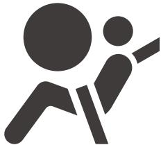
Контрольная лампа подушки безопасности контролирует состояние системы подушек безопасности, цепь системы предварительного натяжения ремня и все связанные цепи. Когда пусковой выключатель находится в положении ON, система сначала выполняет самопроверку, и сигнальная лампа подушки безопасности загорается на несколько секунд, а затем гаснет, указывая на то, что система находится в исправном рабочем состоянии. При
