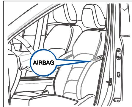
Боковая подушка безопасности установлена на сиденье водителя и на задней части сиденья переднего пассажира, и к ней прикреплена табличка «AIRBAG», указывающая ее местоположение.
