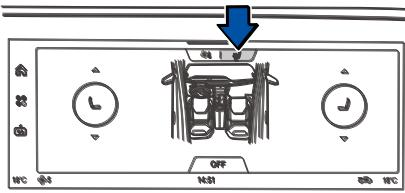
Установите пусковой переключатель в положение ON и нажмите на иконку обогрева сиденья водителя на мультимедийном дисплее, чтобы активировать функцию обогрева сиденья. Снова нажмите на иконку, чтобы отключить функцию обогрева сиденья. Пожалуйста, не включайте обогрев сидений в следующих ситуациях:
