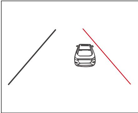
Интерфейс предупреждения модуля комбинации приборов показан на рисунке выше. Когда система слежения за дорожной разметкой обнаруживает, что автомобиль отклоняется от полосы движения, модуль комбинации приборов показывает интерфейс предупреждения и посыпает звуковой сигнал предупреждения о выходе из полосы движения.
