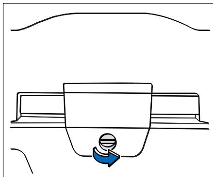
Треугольная предупредительная табличка размещена на задней откидной двери. Чтобы вынуть треугольную предупредительную табличку, сначала поверните ручку крышки треугольной предупредительной таблички против часовой стрелки ( $90^\circ$ ), откройте крышку треугольной предупредительной таблички.
