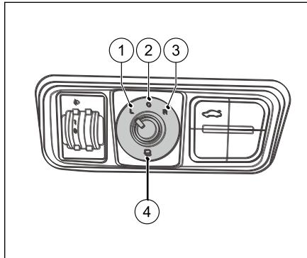
1. Положение L: регулировка левого зеркала заднего вида.
