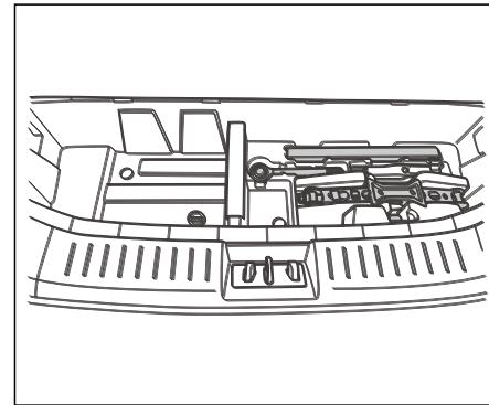
1. Откройте багажник и снимите покрытие пола.
