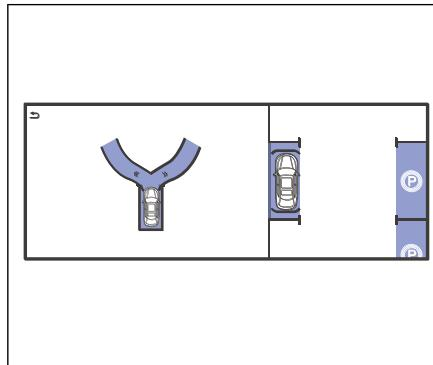
5. После выбора направления старта на экране дисплея экран дисплея перейдет к опции «Начать парковку» ("Start Parking"). После нажатия кнопки «Начать парковку» можно напрямую активировать функцию автоматической парковки. На этом этапе отпустите тормоз и войдите в процесс автоматического старта.
