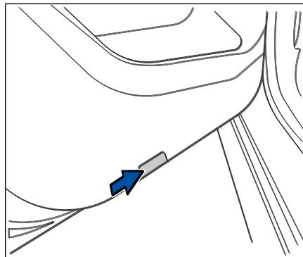
При открытии двери ночью, огни автомобиля, движущегося сзади, падают на отражатель на двери, который в свою очередь, отражает свет, предупреждая приближающегося водителя об открытых дверях.
