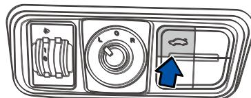
Когда пусковой переключатель находится в положении ON, нажмите и удерживайте переключатель, чтобы закрыть заднюю откидную дверь.
