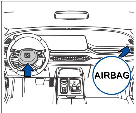
Подушка безопасности расположена в центре рулевого колеса. Фронтальная подушка безопасности пассажира расположена на приборной панели. На нем есть знак «AIRBAG».
