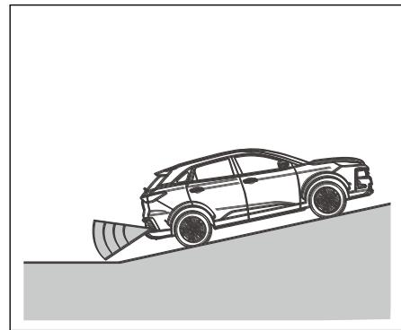
2. Если автомобиль находится на крутом склоне, система реверсивного радара может ошибочно сработать.
