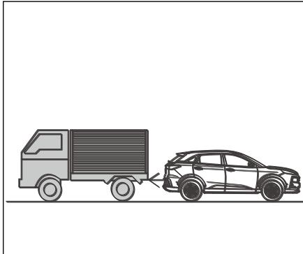
4. Если шумы от клаксонов других автомобилей, двигателей, выхлопных газов и других источников слишком близко приближаются к датчику реверсивного радара, система реверсивного радара может ошибочно сработать.
