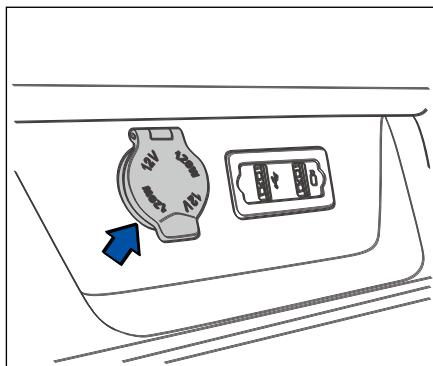
В передней части находится порт USB и 12В гнездо подключения к сети. Порт USB поддерживает передачу данных.
