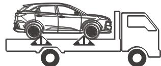
При буксировке грузовой платформой автомобиль должен быть надежно закреплен, как показано на рисунке.
