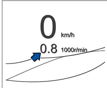
Двигатель быстрее изнашивается и потребляет большее топлива, если во время движения частота оборотов двигателя слишком высока. В большинстве случаев двигатель экономит больше топлива при работе на низких оборотах.
