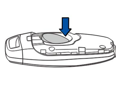
3. Извлеките батарею, нажав на перегородку батареи пальцем или отверткой.
