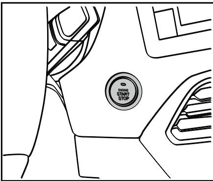
Когда смарт-ключ находится в зоне обнаружения автомобиля, водителю не нужно вынимать ключ из кармана или сумки, для запуска нажмите кнопку пускового выключателя. Перед включением пускового кнопочного выключателя автоматическая коробка передач должна находиться в положении P, а механическая коробка передач должна быть в нейтральном положении.
