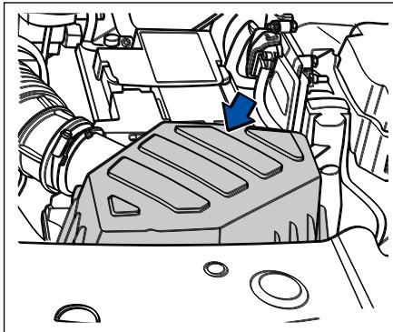
Воздушный фильтр можно чистить при проверке элемента воздушного фильтра. Заменяйте фильтрующий элемент в соответствии с интервалом времени, указанным в руководстве по техническому обслуживанию.
