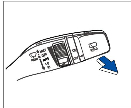
Осторожно потяните рычаг стеклоочистителя по направлению к водителю, и омыватель распылит чистящую жидкость на переднее лобовое стекло. В то же время стеклоочиститель будет продолжать работу на низкой скорости до тех пор, пока рычаг управления стеклоочистителем не будет отпущен.
