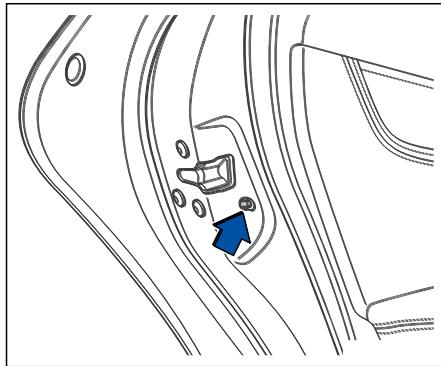
Если установлено данное положение для дверного замка , то функция блокировки детской безопасности активирована. В этом случае, дверь может быть открыта только снаружи.
