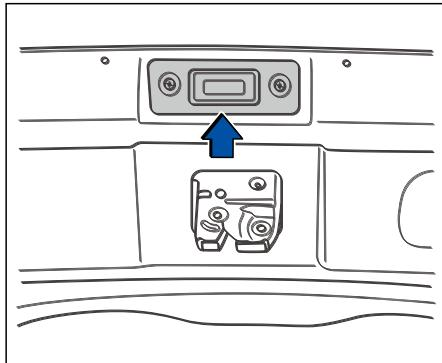
Когда смарт-ключ находится в рабочем диапазоне, нажмите переключатель задней откидной двери и задняя дверь откроется. После закрытия задней откидной двери, она будет автоматически заблокирована.
