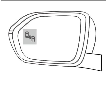
Типы сигнализации функции системы контроля слепых зон:
