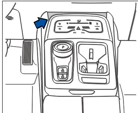
Беспроводная зарядка использует принцип электромагнитной индукции для зарядки мобильного телефона. Зона зарядки расположена в передней части центральной панели управления вспомогательной приборной станции. Поместите заднюю часть мобильного телефона с функцией беспроводной зарядки в центре зоны зарядки. Вы можете включить функцию беспроводной зарядки через кнопку «беспроводная зарядка» в MP5.
