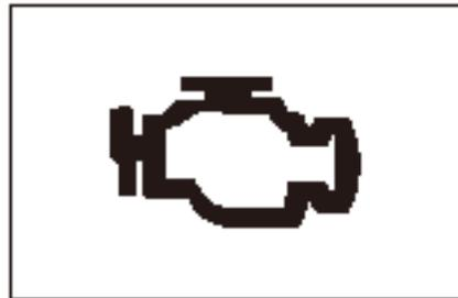
Данный индикатор является составляющей встроенной системы диагностики, которая контролирует процесс выпуска отработавших газов. Индикатор неисправности загорается, когда детали, относящиеся к выхлопной системе, выходят из строя или выхлопная система не работает должным образом, вследствие чего результаты регулирования выхлопа неудовлетворительны. Данный индикатор загорается при включении зажигания в положение «ON» и гаснет сразу после запуска двигателя.
