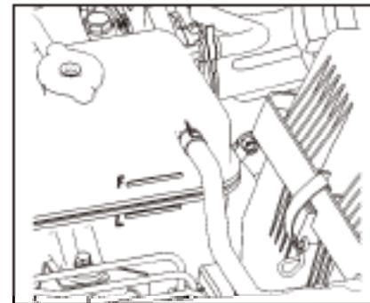
8. Проверьте уровень охлаждающей жидкости. Проверьте уровень охлаждающей жидкости в расширительном бачке. Если уровень жидкости ниже нижней границы отметки -L, добавьте охлаждающую жидкость. Добавляемая охлаждающая жидкость не должна превышать верхний предел метки расширительного бачка-F. Проверьте уплотнение и рабочее состояние давления крышки расширительного бачка.
