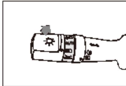
Поверните цилиндрическую ручку переключателя в положение «☀» на конце рычага переключения светового сигнала поворота и света фар и потяните рычаг переключателя вперед, пока не услышите «щелчок», указывающий на включение дальнего света. Индикатор дальнего света загорится на панели приборов при включении дальнего света. Чтобы переключиться на ближний свет, просто потяните рычаг переключателя назад.
