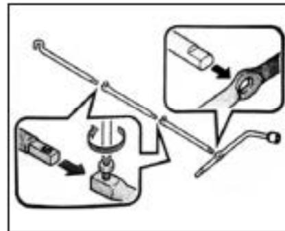
Синтезируйте гаечный ключ для колесной гайки и два узла подъемной штанги и заводную рукоятку, как показано на рисунке.
