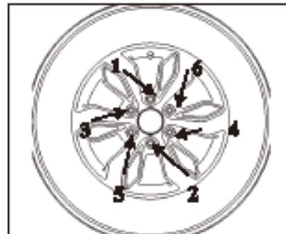
4. Используйте колесный ключ, чтобы затянуть колесную гайку в указанной ниже последовательности. В этом случае следует надежно затянуть следующие значения момента затяжки. Момент затяжки колесной гайки (Н • м).
