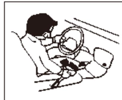
Попадание воздуха в гидравлический контур сцепления приведет к неполному отключению сцепления. Поэтому, если объем жидкости в баке для хранения жидкости сцепления недостаточен, это приводит к ее вытеканию, или при необходимости извлечения гидравлического контура, убедитесь, что имеется выхлоп гидравлической системы сцепления. Вытяжные работы должны координироваться двумя людьми.
