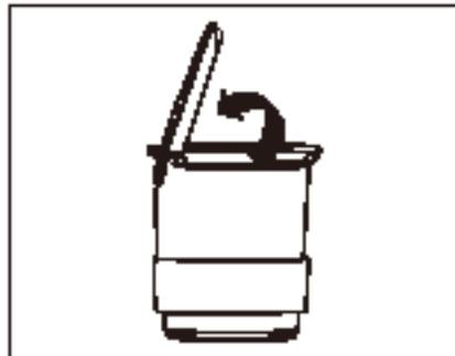
Передвижная пепельница находится с правой стороны от механизма переключения передач; при использовании крышку пепельницы можно поднимать. Если вам нужно ее почистить, просто выньте. После использования пепельницы обязательно закройте крышку пепельницы. В противном случае от горячей сигареты воспламятся другие окурки, создавая опасность пожара.
