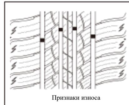
Проверьте следы износа на шине. Следы износа являются знаками безопасности. Если следы износа перешли в положение отметки износа, немедленно замените их.
