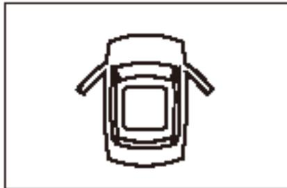
Если какая-либо дверь не закрыта или плохо закрыта, то загорается этот индикатор, чтобы напомнить, что нужно хорошо закрыть дверь. После правильного закрытия двери индикатор погаснет.
