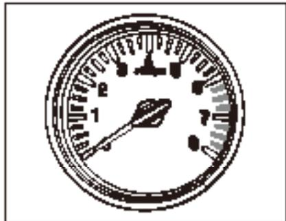
Тахометр показывает информацию по количеству оборотов двигателя в минуту (об/мин), красная зона указывает предел числа оборотов двигателя в минуту.
