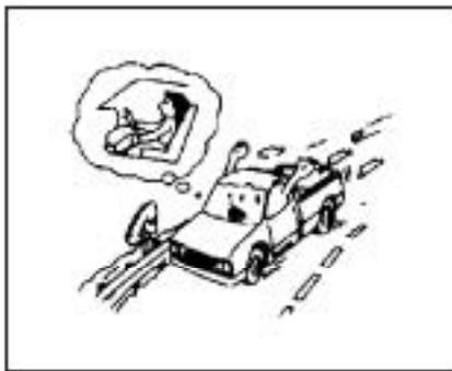
7. При движении под уклон, чтобы получить эффект торможения двигателем, рычаг переключения передач должен быть переведен на низшую передачу.
