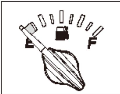
Указатель уровня топлива показывает приблизительное количество топлива в топливном баке. Символы «F» и «E» обозначают «полный» и «пустой» соответственно.
