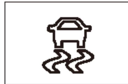
Индикатор ESC загорается при включении зажигания и гаснет примерно через 3 секунды. Когда система ESC запускается, она контролирует состояние движения, а при нормальных условиях движения индикатор ESC остается выключенным. Если во время движения индикатор ESC мигает, это означает, что дорога скользкая и мощность автомобиля достигает максимального предела сцепления. Если система ESC неисправна, индикатор горит постоянно. Обратитесь в официальный сервисный центр JAC, чтобы проверить систему.
