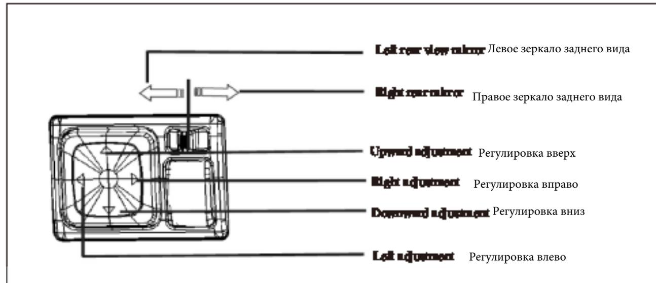
Используйте этот переключатель для регулировки угла зеркала заднего вида
