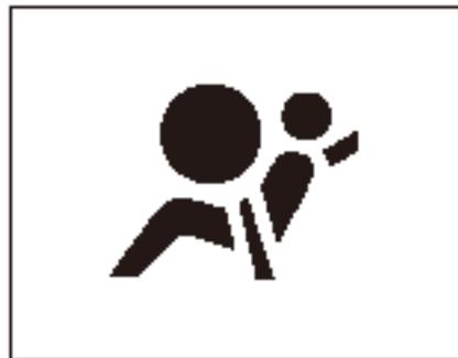
На приборной панели установлен индикатор подушки безопасности (показан справа), на котором отображается символ подушки безопасности. Как только будет запущен двигатель автомобиля, система проверит исправность подушек безопасности, а также проверит на наличие каких-либо электрических неисправностей. Системные проверки включают датчики подушек безопасности, модули подушек безопасности, электрические и диагностические модули. При запуске автомобиля, загорается индикатор
