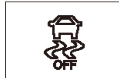
Нажмите кнопку переключателя ESC OFF, после этого загорится индикатор ESC OFF, указывая на то, что система ESC не работает.
