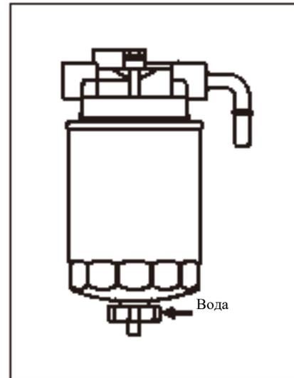
Если загорелся индикатор топливного фильтра, рекомендуется слить воду из фильтра тонкой очистки и фильтра одновременно. Для слива необходимо выполнить следующие шаги.
