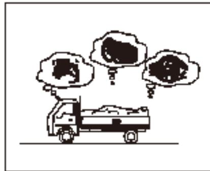
12. Никогда не останавливайте двигатель во время движения, иначе эффект торможения будет снижен из-за остановки усилителя тормозов. Если во время движения пусковой выключатель установлен в положение «LOCK», это чрезвычайно опасно, поскольку рулевое колесо заблокировано и управление автомобилем невозможно.
