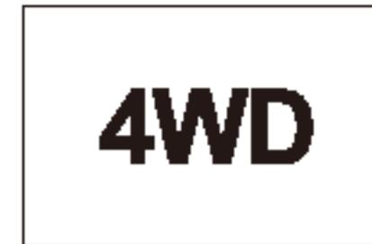
Индикатор горит, когда автомобиль находится в высокоскоростном режиме системы полного привода.
