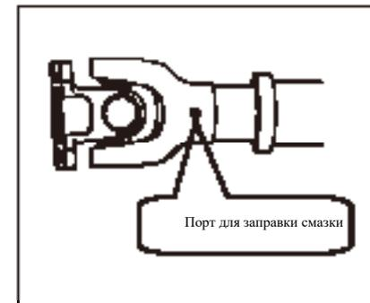
Пожалуйста, смажьте следующие детали универсальной смазкой. Используйте консистентную смазку Foss EPT-2.5 для смазки следующих деталей: скользящая втулка
