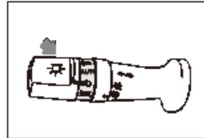
Чтобы включить сигнализацию дальним светом фар, слегка потяните на себя рычаг переключения светового сигнала поворота и света фар, а затем отпустите его. Дальний свет загорится и погаснет. Даже если рычаг переключения светового сигнала поворота и света фар остается в положении OFF, головные фары могут мигать. Слегка потяните на себя рычаг переключения светового сигнала поворота и света фар и удерживайте его. Дальний свет не погаснет, пока вы не отпустите рычаг.
