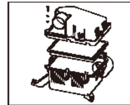
Снятие фильтрующего элемента (расположен спереди справа в моторном отсеке). Снимите верхние и нижние болты крышки воздушного фильтра и откройте зажим крышки фильтра, для извлечения фильтрующего элемента. Очистка корпуса и крышки воздушного фильтра. Удалите пыль с верхней и нижней внешней крышки корпуса воздушного фильтра и с поверхности уплотнительной прокладки.
