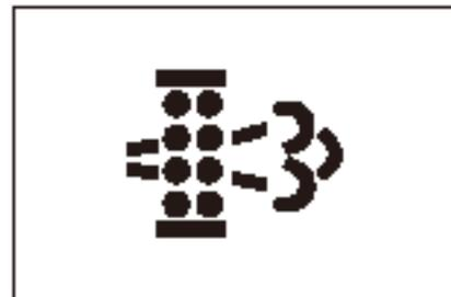
Данный индикатор загорается, если в системе постобработки слишком много углерода или если выполняется регенерация.
