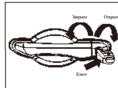
Чтобы запереть дверь снаружи автомобиля, вставьте ключ и поверните его по часовой стрелке. Чтобы разблокировать, поверните ключ против часовой стрелки.
