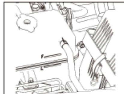
Проверьте антифриз в расширительном баке. Нет необходимости открывать входную крышку расширительного бачка, если в этом нет особой необходимости. Для получения подробной информации, пожалуйста, обратитесь к разделу «Техническое обслуживание».
