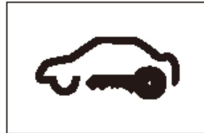
Если замок зажигания находится в положении «ON» и ключ успешно идентифицирован, индикатор гаснет и остается в отключенном состоянии. При ошибочной идентификации ключа, индикатор мигает с интервалом 0,5 секунды. В таком случае автомобиль нельзя запускать.
