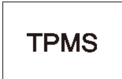
Данный индикатор загорается при неисправности системы контроля давления в шинах, например, при повреждении датчика давления в шинах.
