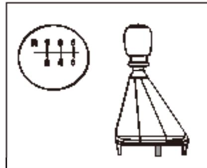
5. Перед движением задним ходом и после движения задним ходом автомобиль необходимо обязательно остановить перед переключением рычага переключения передач на передачу заднего хода или переключением на первую передачу.
