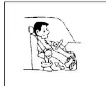
3. При ускорении рычаг переключения передач следует перевести на высокую передачу, а затем медленно отпустить педаль сцепления.
