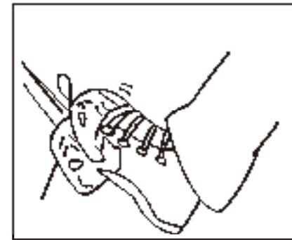
9. Проверьте зазор и высоту педали тормоза, рабочую исправность
