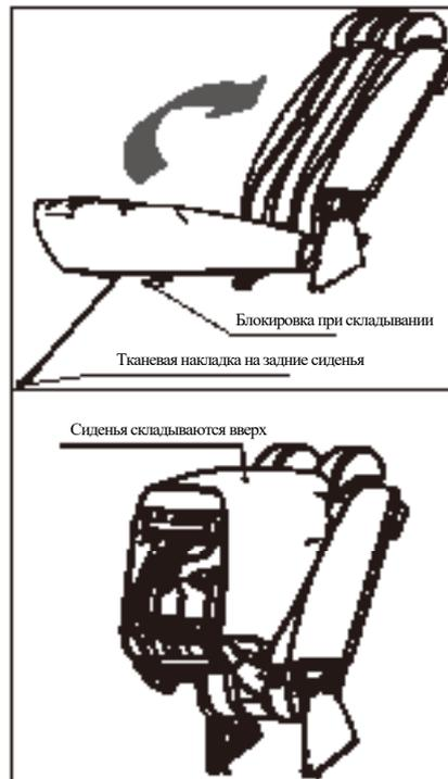
Подушка заднего сиденья откидывается. Потяните за подушку заднего сиденья, чтобы соединить тканевую полосу, ослабьте нижний фиксатор, чтобы поднять подушку сиденья. И воткните крючок в средний фиксатор задней металлической детали.
