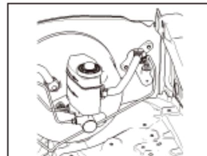
Бак для хранения жидкости установлен на левой передней стенке панели приборов и является общим с баком для тормозной жидкости.
