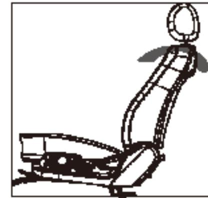
В вашем автомобиле есть ручка для ручной регулировки наклона спинки сиденья, которая находится снаружи сиденья.
