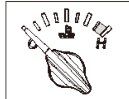
Указатель показывает температуру охлаждающей жидкости двигателя при включении зажигания.
